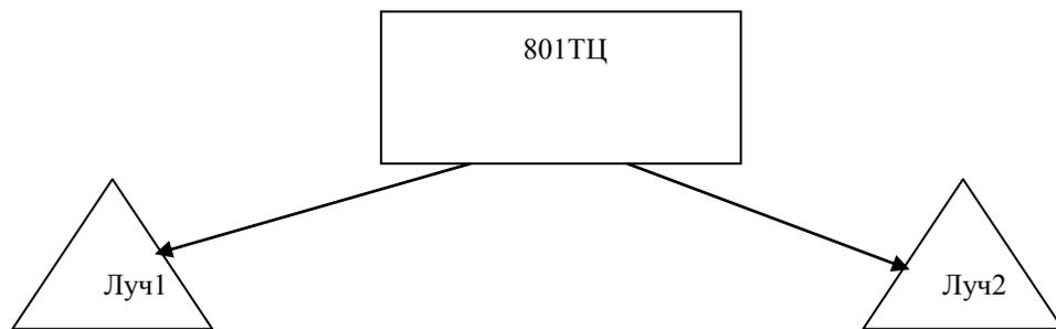
Существующая система теплоснабжения п. Видяево– 2-х трубная, тупиковая с закрытым горячим водоснабжением. Существует два луча системы теплоснабжения
